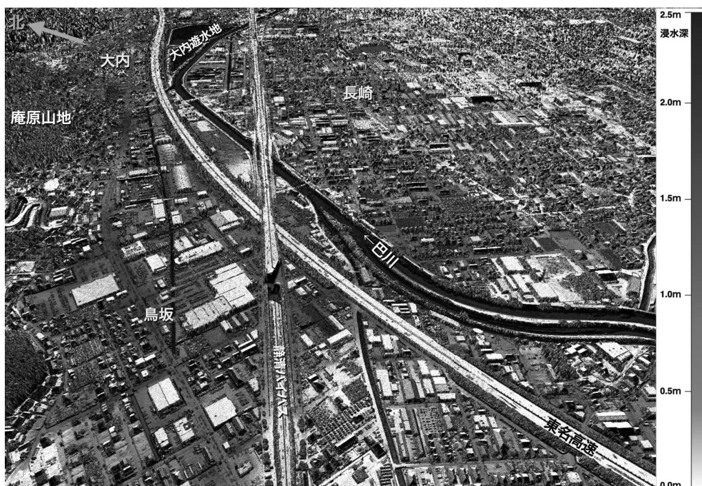
図2 2022年台風15号豪雨によって氾濫した巴川流域の浸水深分布を示す3Dマップの例（小山，2023b）
