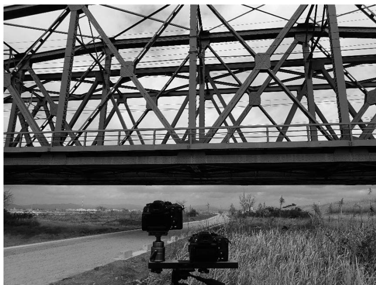
橋梁のたわみ計測の例
