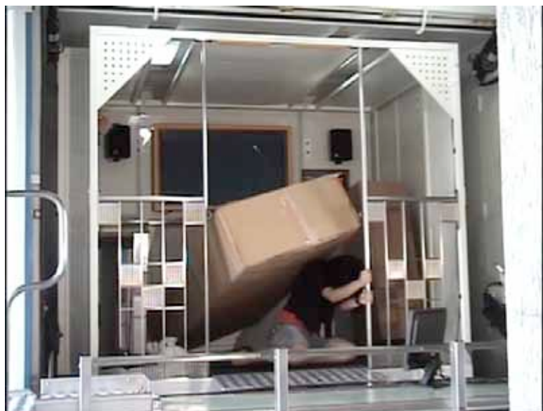
写真 2-2 起震車を用いた緊急地震速報の効果検証実験の様子
